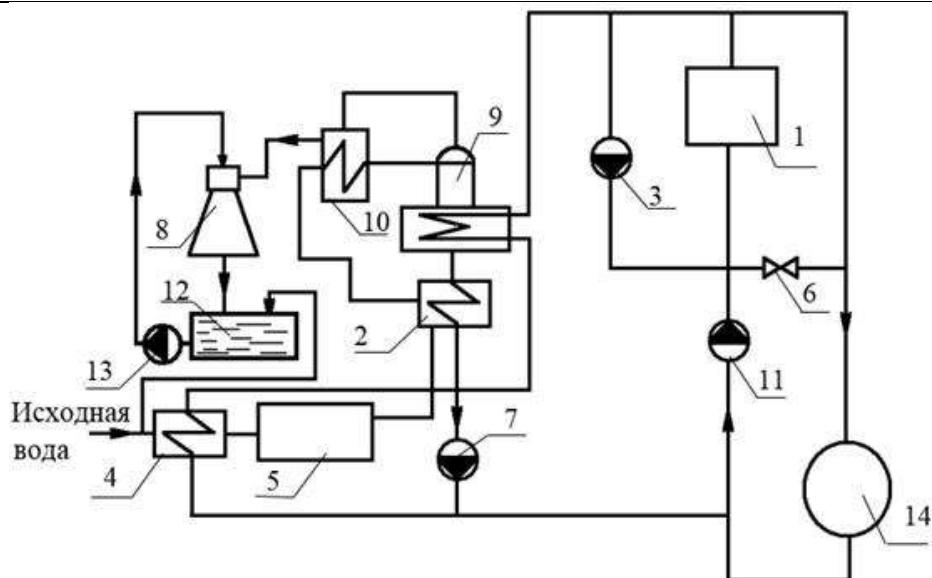
Рис.1. Принципиальная тепловая схема отопительной котельной с водогрейными котлами:
